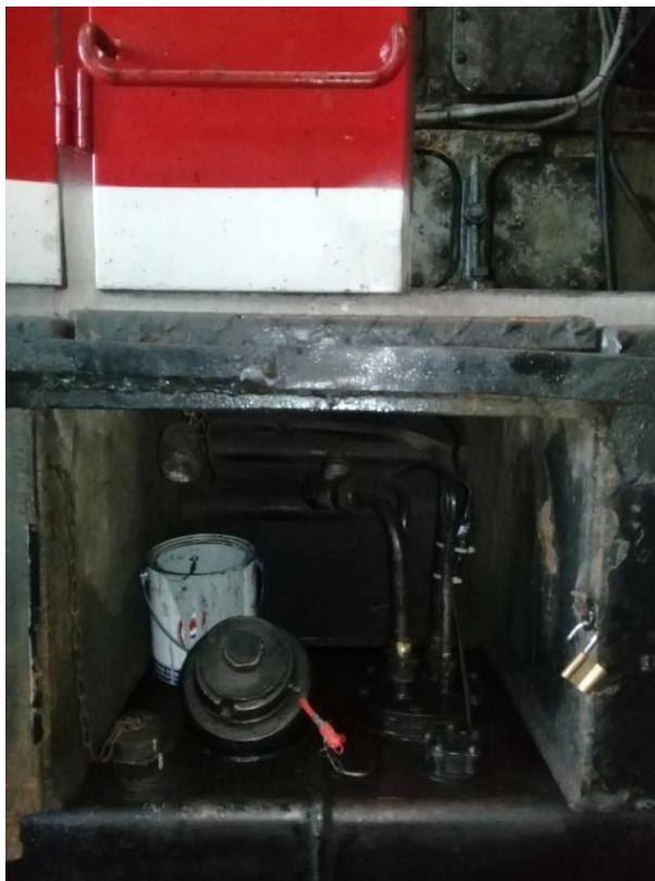
Hình 1.12. Hình ảnh cảm biến nhiên liệu được lắp vào tầng đe nhiên liệu của tàu hỏa thử nghiệm
