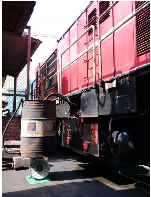
Hình 1.9. Định lượng chính xác lượng tiêu hao nhiên liệu bằng cân cơ học
