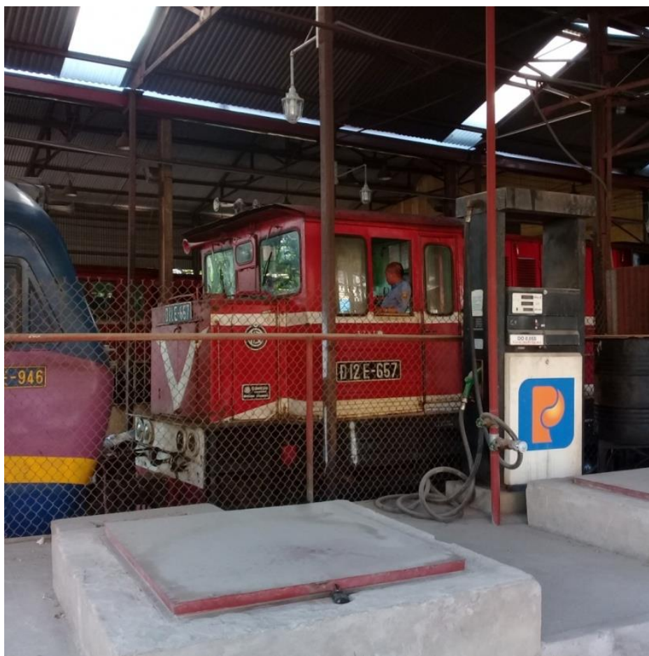
Hình 1.19. Hình ảnh tàu đổ ở vị trí vạch trắng kẻ sơn trên hông tàu, ngang với vạch trắng sơn trên cột nhà/ cột thép cạnh cây cấp dầu quy định
