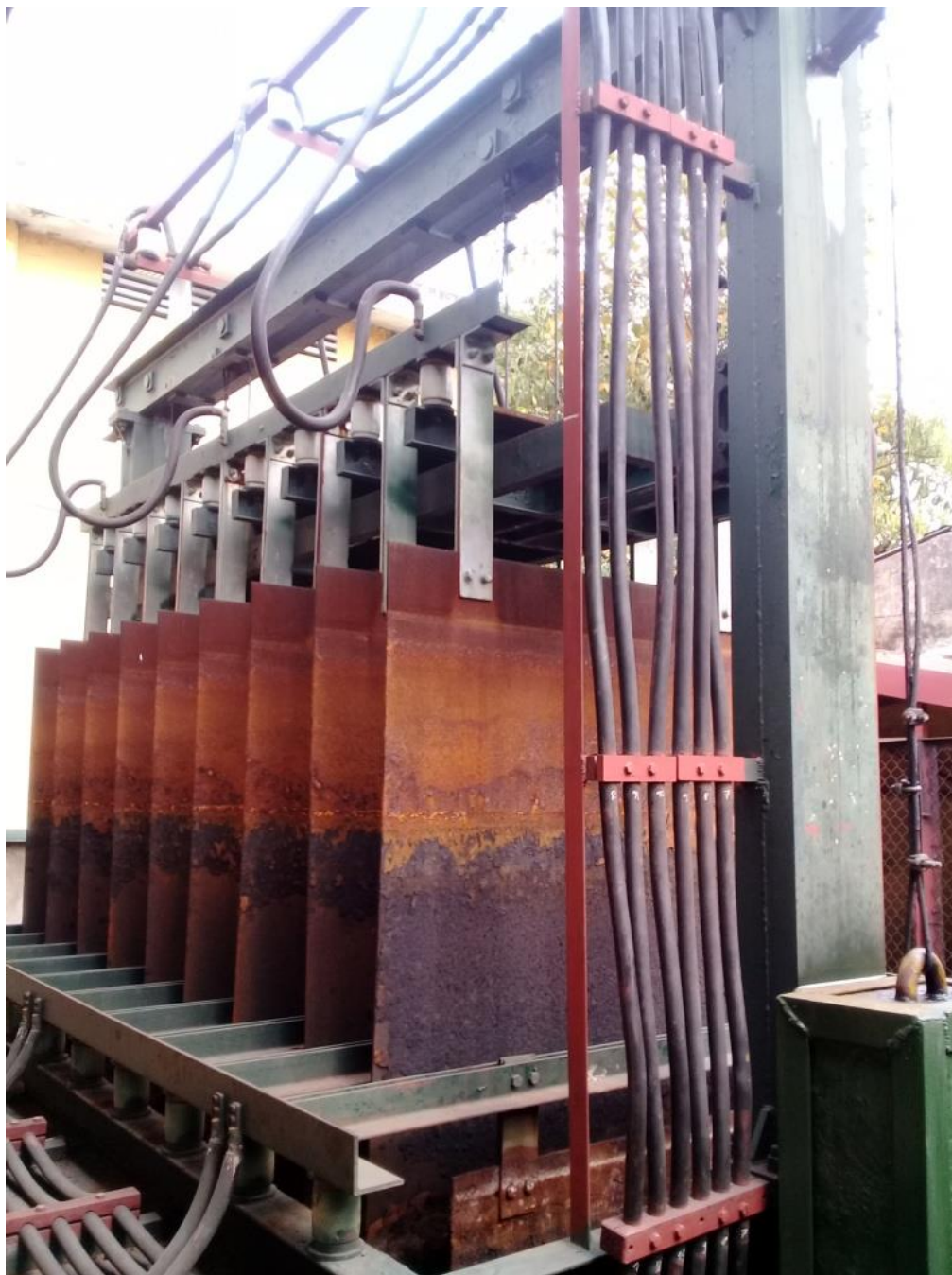
Hình 1.6. Hình ảnh các bản cực của Bồn thử công suất
