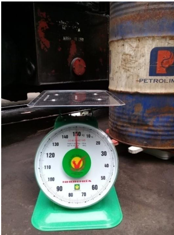
Hình 1.9. Định lượng chính xác lượng tiêu hao nhiên liệu bằng cân cơ học
