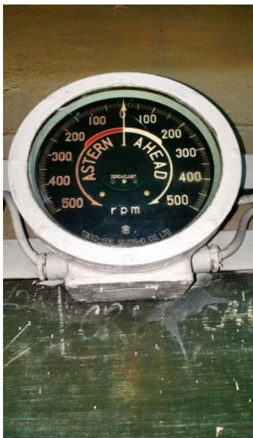
Hình 1.12. Đồng hồ đo vòng quay máy chính 6L27BSH
