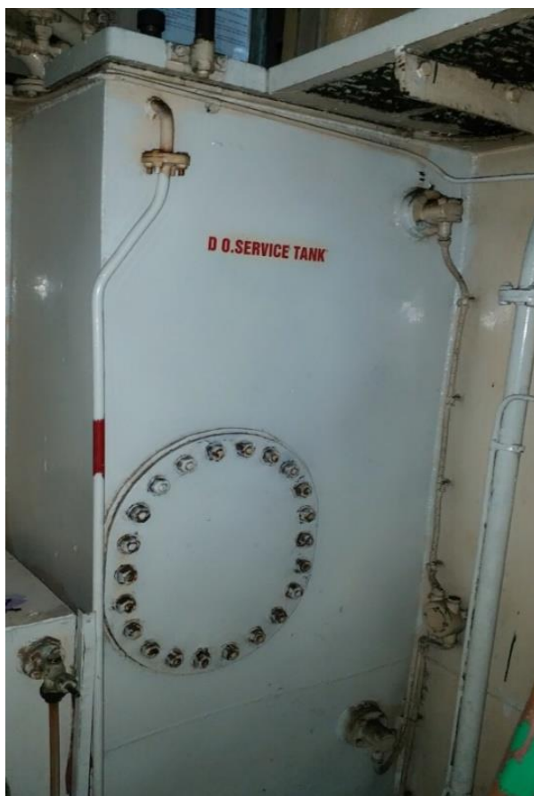
Hình 1.9. Két trực nhật nhiên liệu (1.000 lít) của tàu Sao Biển
