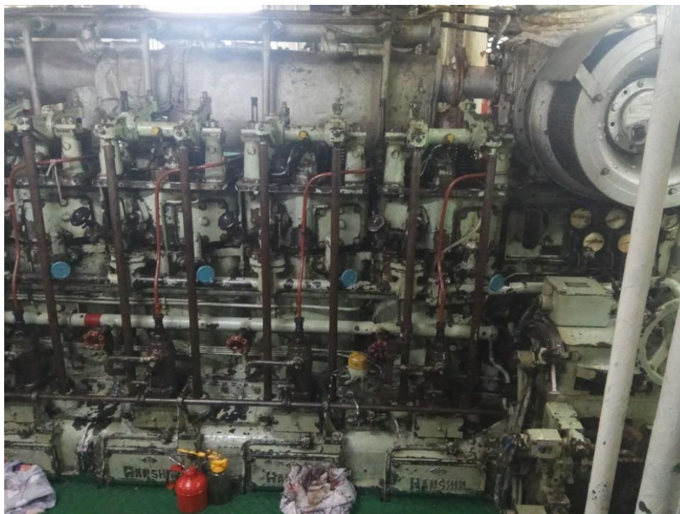
Hình 1.10. Động cơ chính 6L27BSH của tàu Sao Biển
