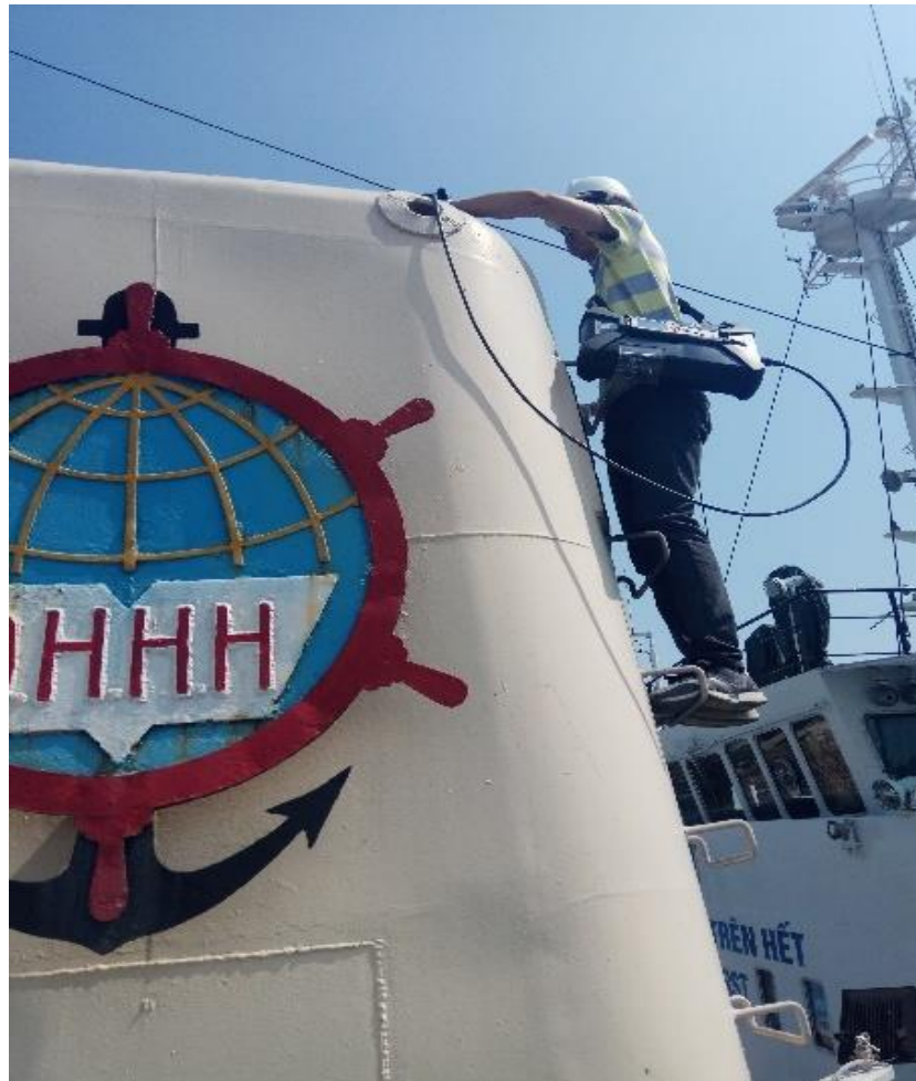
Hình 1.14. Thực nghiệm đo khí thải
