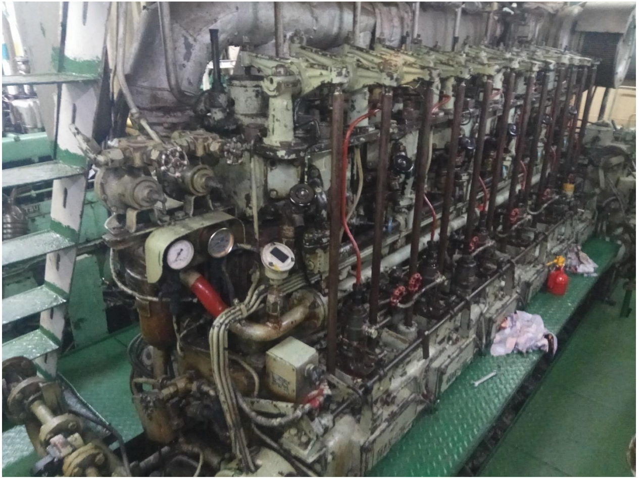
Hình 1.4. Máy chính 6L27BSH trên tàu biển Sao Biển
