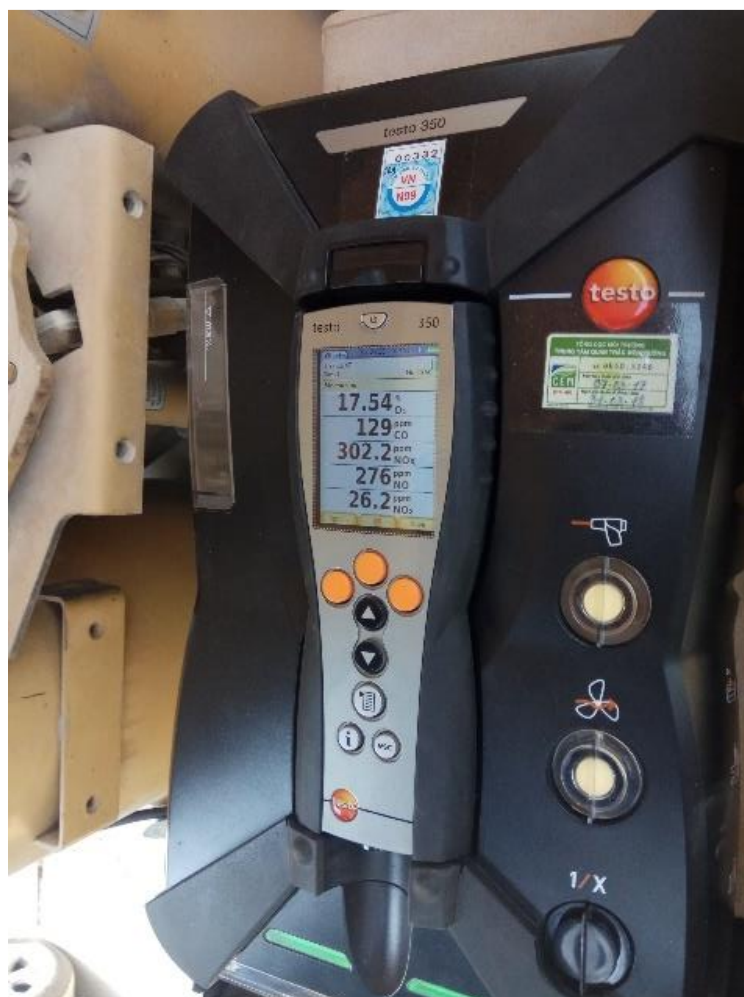
Hình 1.13. Máy đo khí thải Testo 350
