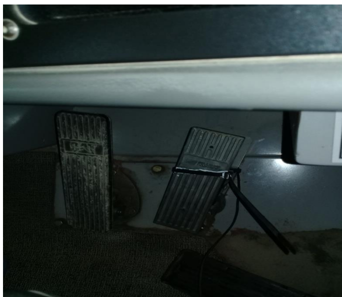
Hình 1.9. Hệ thống chân ga của xe CAT 769D được cố định
