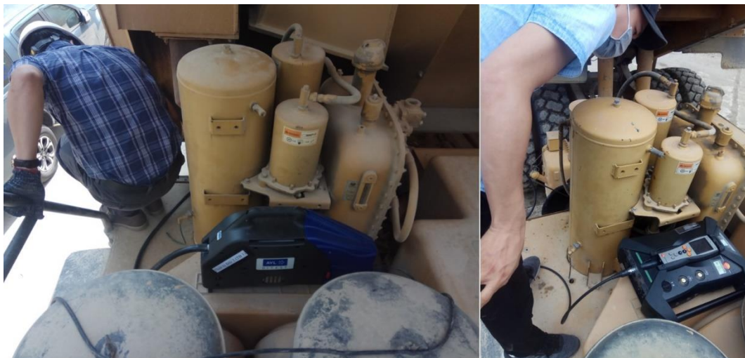
Hình 1.15. Thực nghiệm đo khí thải
