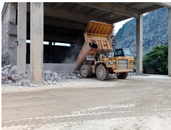
Hình 1.14. Vị trí đổ tải/trạm đập đá vôi
