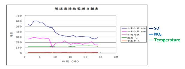
⇒台电林口电厂(SOx)排放量降低46%及(NOx)排放量降低42%
