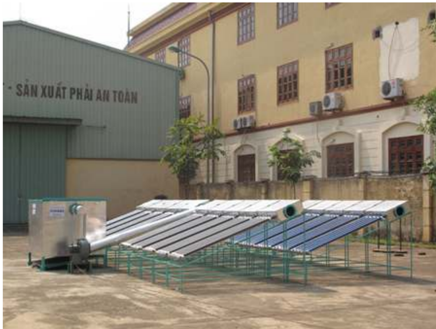
Máy sấy nông sản/lúa bằng năng lượng mặt trời sử dụng ống nhiệt thủy tinh chân không
